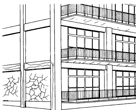
RC建築物の屋外面のひび割れの例
