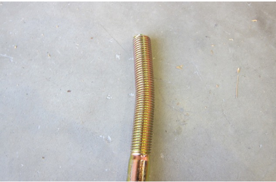
写真 5.3 代表的な破壊性状 (No. 4)
