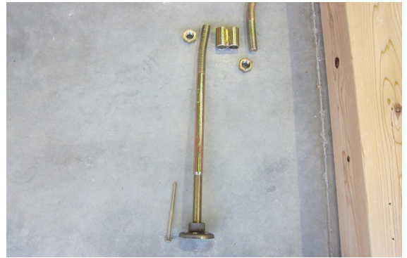
写真 5.4 代表的な破壊性状 (No. 6)
