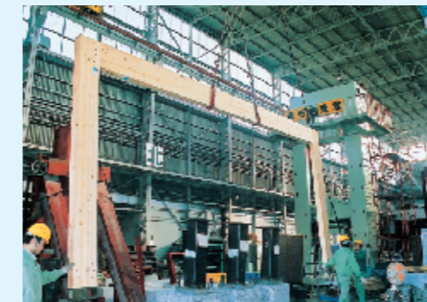
木造門型フレーム接合強度実大実験風景
