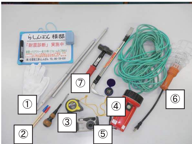
写真2：耐震診断時に役立つ七つ道具
