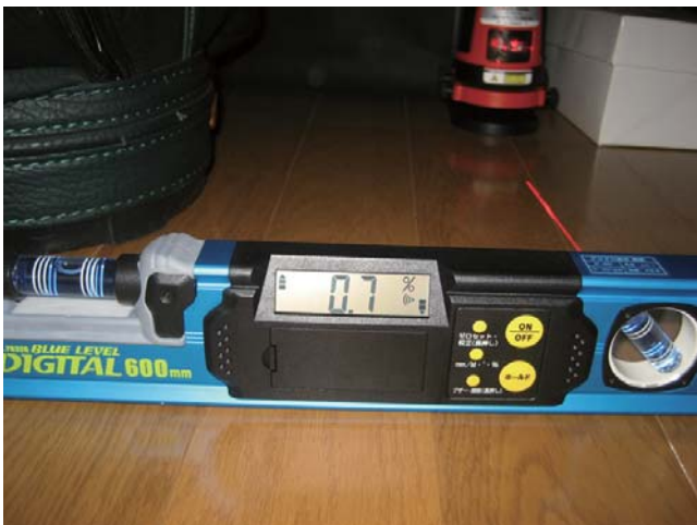
建物の傾斜の測定はデジタル水平器（手前）やレーザー（右奥）を用いる。
