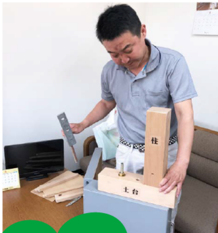
◀ホールダウン金物の必要性を伝えるために使用されている「ホゾ抜け模型」
