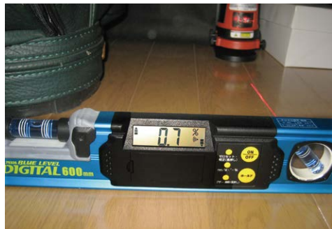
【写真⑥】デジタル水平器(手前)やレーザー(右奥)で建物の傾斜の測定
