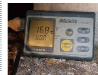
【写真①】 床下の測定とともに、外気についても測定し、比較検討することが重要
