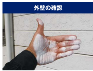
▲モルタル壁もサイディング材も表面の塗膜の劣化は手でなぞり白い粉が付着するようなら、塗替えの時期
