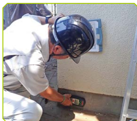
◀基礎の鉄筋検査の様子
